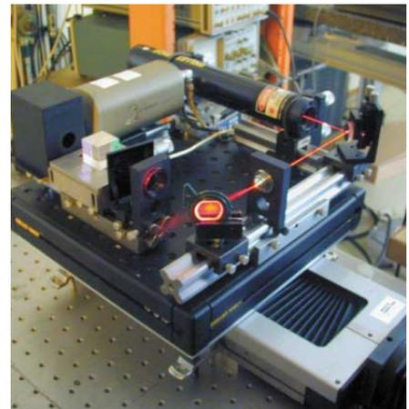
Figure 2 : Banc d'holographie électronique courte distance pour l'imagerie à synthèse d'ouverture.
