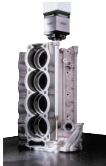
palpeur est encombrant, plus sa fréquence propre (et donc sa vitesse de palpé) sera faible...
