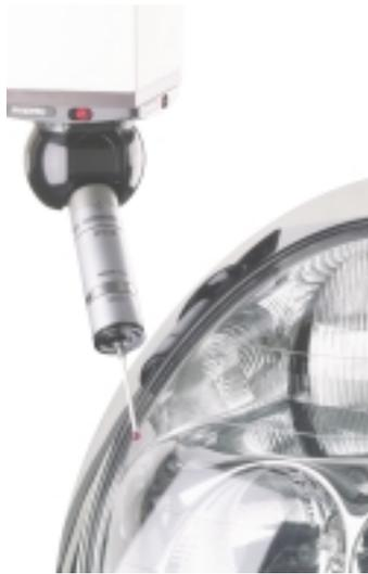
La compacité est un précieux atout des palpeurs à contact... Avec un diamètre d'à peine 25 mm, le dernier palpeur mesurant SP 25 de Renishaw est un modèle du genre.
